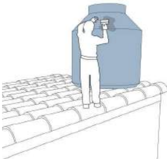
Reparación: Rellenado de fisuras en el tanque por personal calificado.
