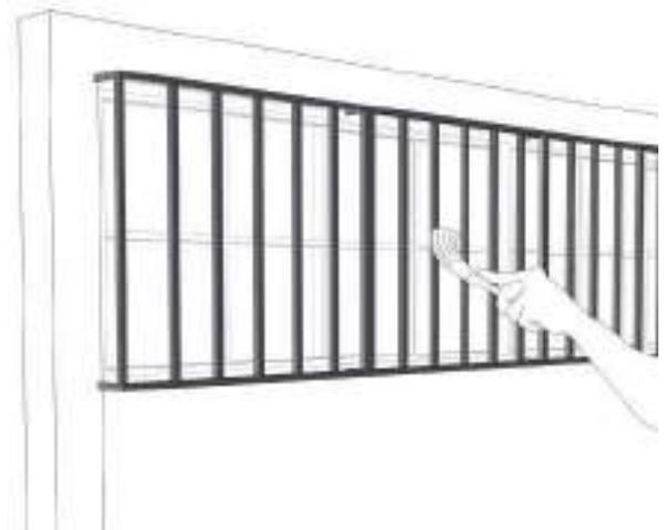
**Reparación:** Aplica base anticorrosiva o zincromato.
