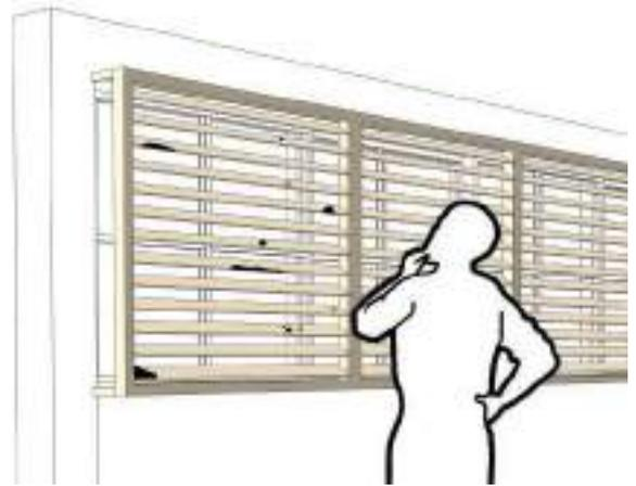
**Reparación:** Identificar los listones de madera que estén deteriorados y desprenderlos.
